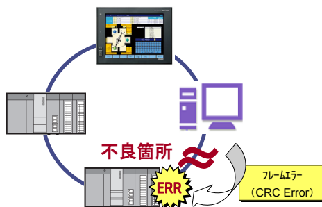
図8 ケーブル不良箇所の特定
